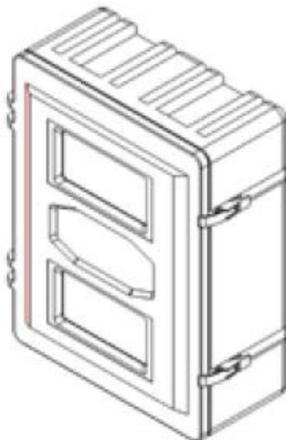
Fixation par vis et chevilles traversant le fond du coffre (non livrées car dépendent de la nature du mur).
