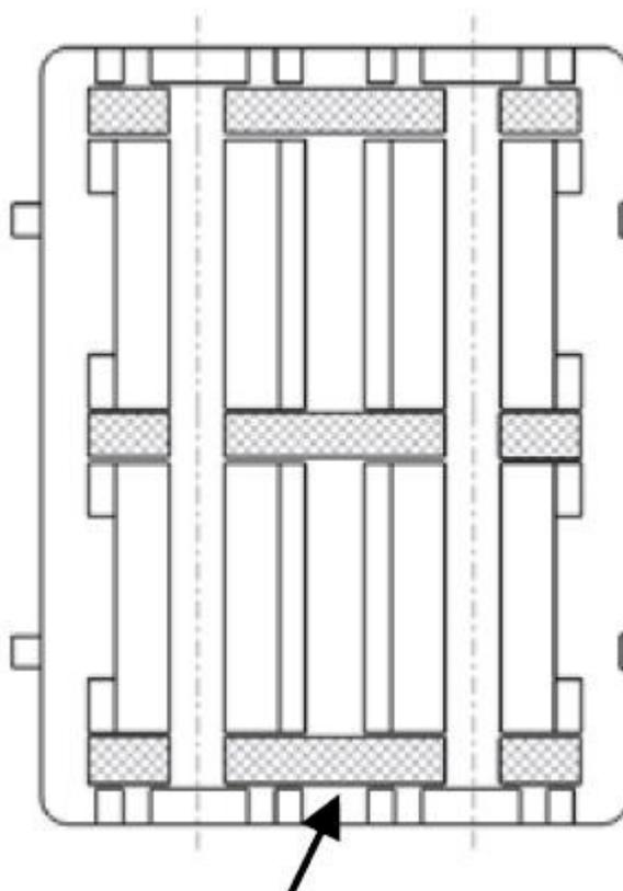
Les emplacements striés sur le schéma ci-dessus sont les zones de fixation recommandées.
