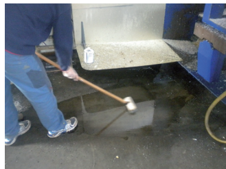
Etape 3 : à l'aide d'un balais brosse, nettoyer et rincer la zone
